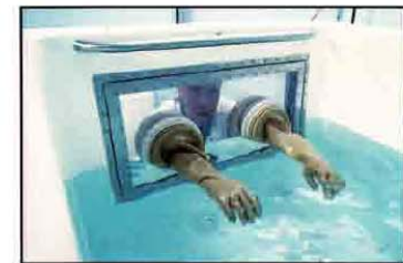
Un projecteur et des hydrojets frontaux permettent de conserver la clarté du liquide et les gants en latex autorisent tous types de manipulations.
